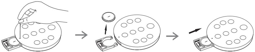
Wenn die Fernbedienung in einem Umkreis von 4 Metern um den Ventilator nicht funktioniert, muss die Batterie ausgetauscht werden. Batterie-Typ: CR2025 oder CR2032. Gehen Sie wie folgt vor, um die Batterie zu wechseln:
