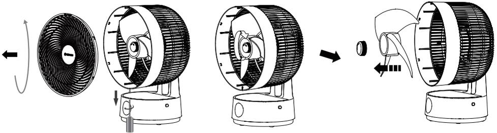
1. Lösen Sie mit einem Schraubenzieher die Schraube an der Unterseite des Ventilatorkopfes.
