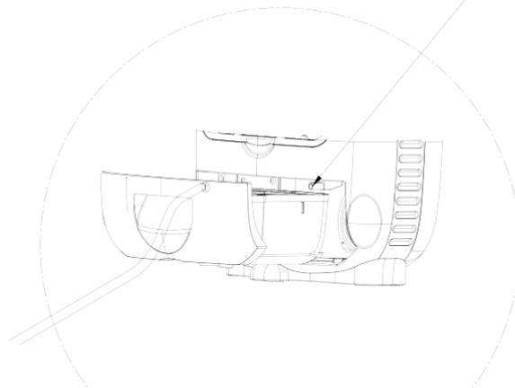
Falls Sie bemerken, dass das Wasser nicht durch den Schlauch abfließt, stellen Sie sicher, dass der Schlauch nach unten führt, nicht abgeknickt ist, überschüssiges Schlauchmaterial abgeschnitten wurde und keine Verstopfungen vorliegen. Falls das Wasser dennoch nicht abfließt, bohren Sie oben in den Schlauch, 30 mm von der Abflussöffnung entfernt, ein 4 mm großes Loch. Dies sorgt für einen Luftdruckausgleich, wodurch das Wasser abfließen kann.
